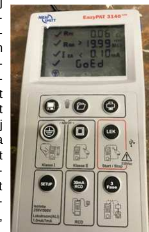
De meter geeft aan dat het apparaat elektrisch goed is
